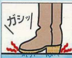
滑り止め材入りゴム靴底の例
